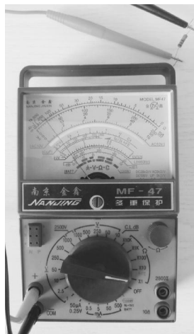
图 8 用 R \times 10 档测量 150\Omega 电阻
