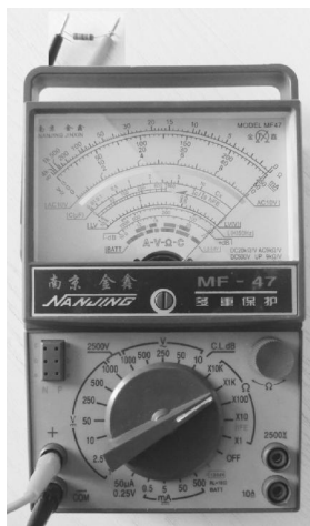
图 6 用 R \times 1k 档测量 150\Omega 电阻
