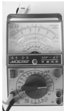
图 9 用 R \times 1 档测量 150\Omega 电阻
