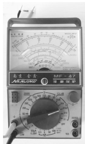
图 7 用 R \times 100 档测量 150\Omega 电阻
